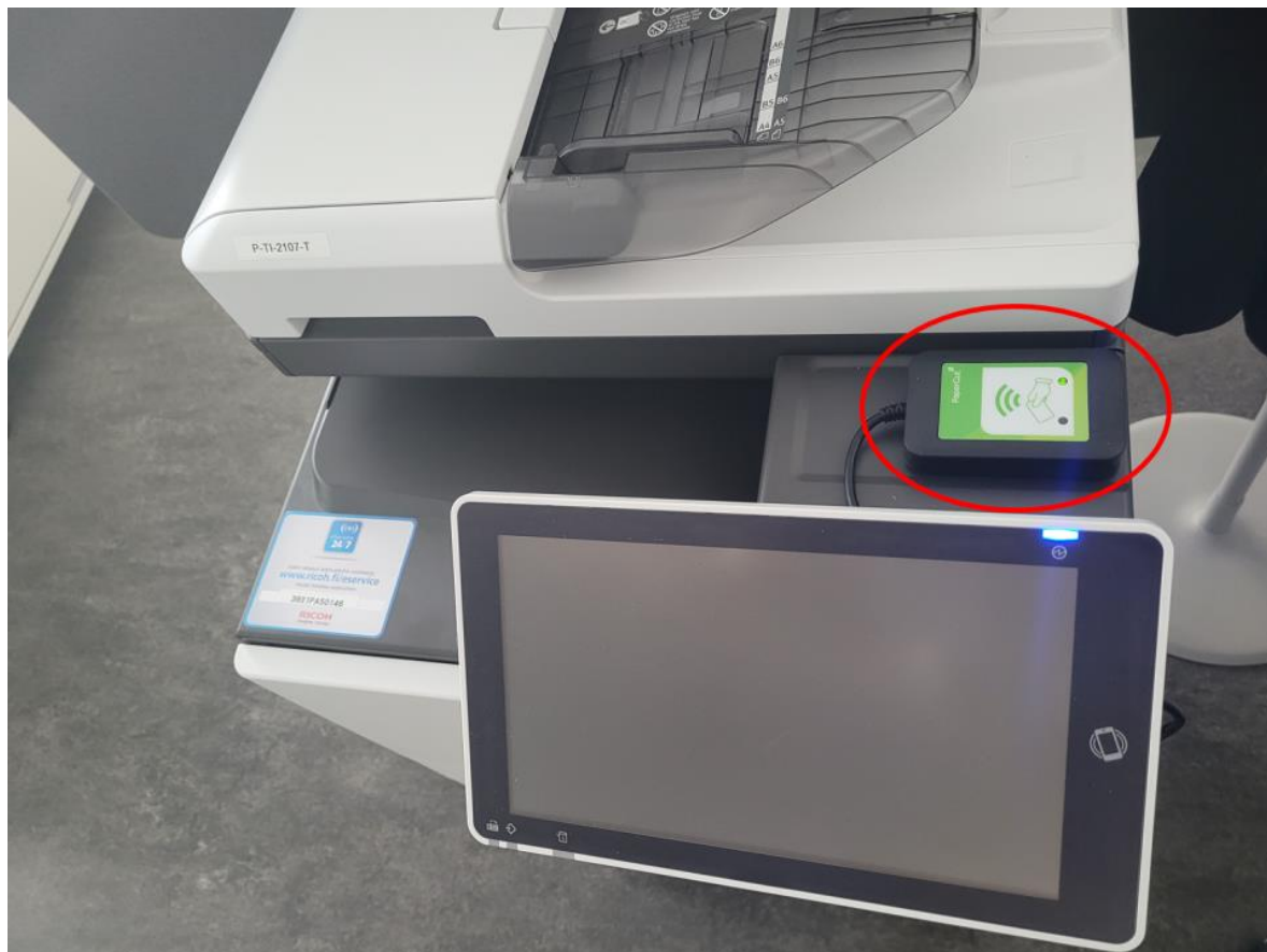
Kuva 1 Ricoh monitoimilaitteen kortinlukija ympyröity punaisella.
